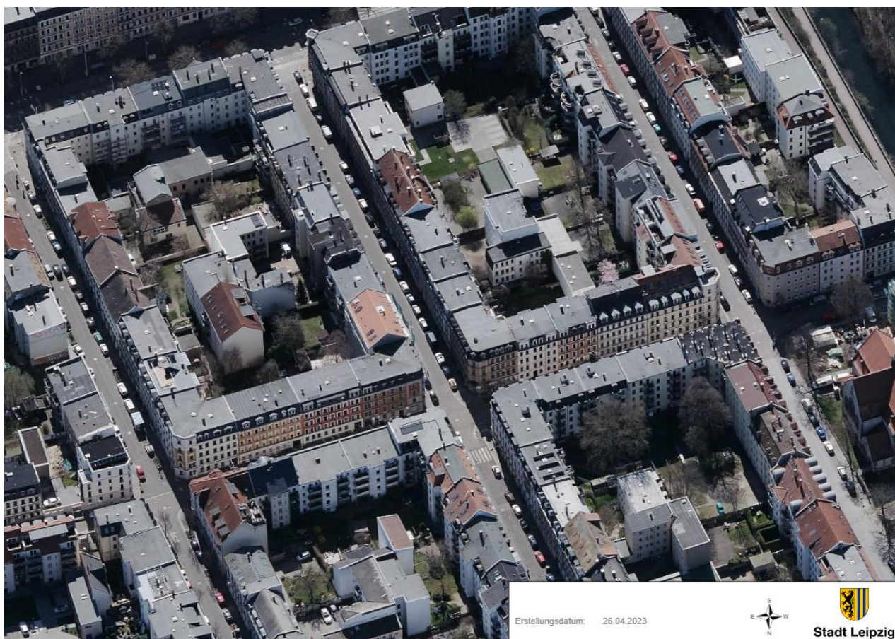
Bild 17: Mansardpultdächer („Leipziger Dach“) und vereinzelt Satteldächer an der GutsMuthsstraße Ecke Aurelienstraße von Northwest. Quelle: Stadt Leipzig, in Kooperation mit GeoFly GmbH
